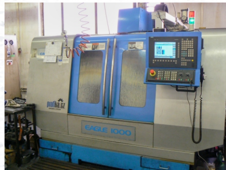
vertikální obráběcí centrum Profimill Eagle 1000 systém Sinumerik
