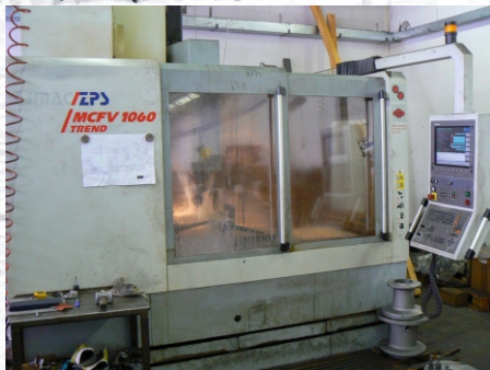
2x vertikální obráběcí centrum TAJMAC-ZPS 1060 MCFV systém Heidenhain
